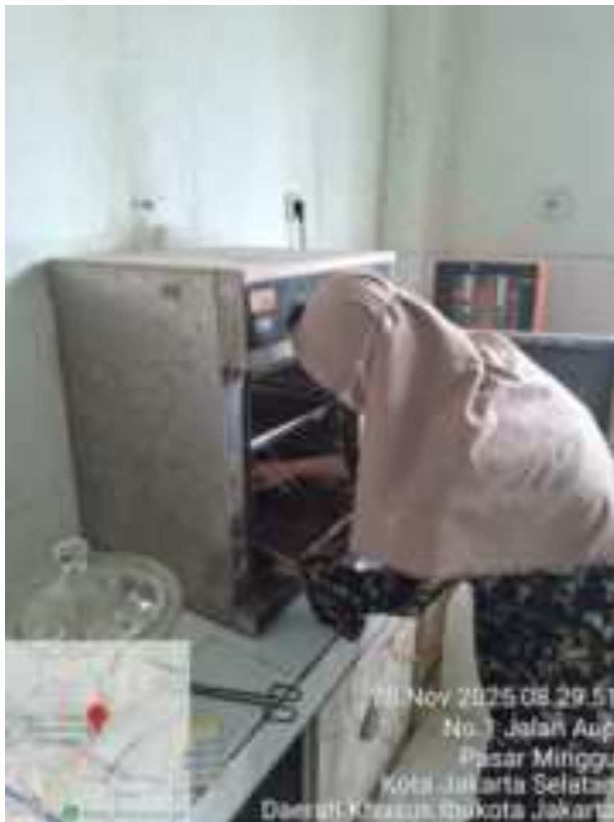
Gambar Bukti proses kalibrasi Oven Memmert.
